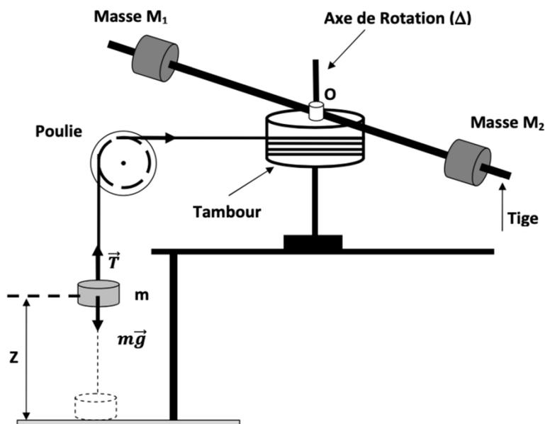
Figure 1 : Schéma du dispositif expérimental de mesure
