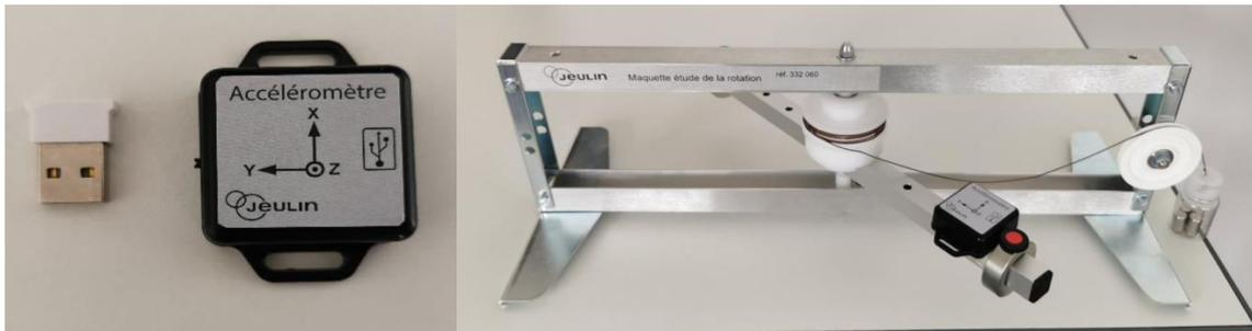
**Figure 2 :** Accéléromètre utilisé pour les mesures (gauche) et installation sur la tige (droite)
